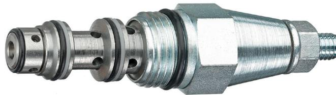
Abschaltventile schalten den Förderstrom einer Pumpe drucklos zum Tank, wenn der Druck im Hydrauliksystem den am Abschaltventil eingestellten Druck übersteigt. Außerdem gewährleistet das Abschaltventil die Druckabsicherung der Pumpe. Die Ventile sind in zwei Ausführungen erhältlich:
